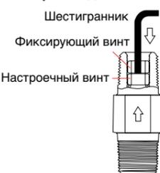
1. Ослабьте немного фиксирующий винт.
