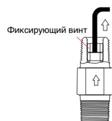
4. Выньте ключ до фиксирующего винта и затяните его.
